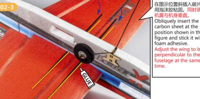
在图示位置斜插入碳片, 用泡沫胶粘固。同时调
