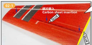
在机翼预留槽埋入碳片, 长度按实际需要裁剪。并 在图示位置涂抹泡沫胶。左右机翼相同操作。 Embed carbon sheet in the reserved slot of the wing and cut the length according to the actual needs.
