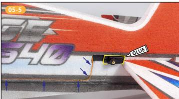
在机身尾部舵机槽内安装舵机,如图安装。 舵机线埋入预留槽内,并引导到机身头部。 用泡沫胶粘固。
