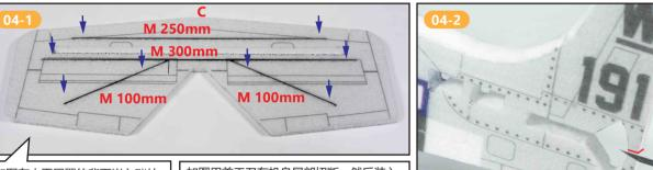
如图在水平尾翼的背面嵌入碳片用泡沫胶粘固。
